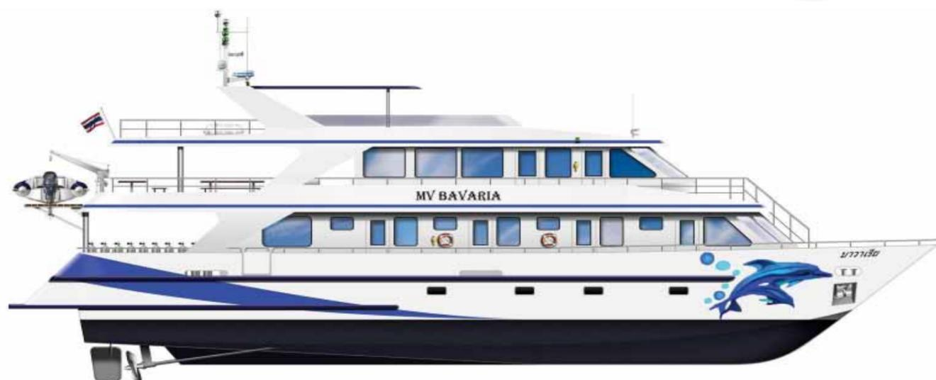
Die MV Bavaria ist ein Stahlschiff mit 28 Metern Länge und 6,5 Metern Breite und unter deutschem Management. Der Stapellauf erfolgt im September 2016 und ab November 2016 starten die ersten Similantouren und Safaris nach Myanmar.
